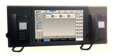
语音调度业务系统由调度台维护系统和调度台组成,实现正常电话的调度以及录音和话单的查询。
